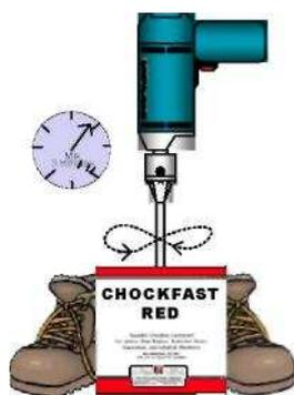
Налейте отвердитель CHOCKFAST Red в смолу CHOCKFAST Red и перемешивайте 3-4 минуты с помощью лопастной мешалки типа "Jiffy" и 1/2" (12 мм) низкоскоростной дрелью. Прежде чем начинать смешивание, полностью погрузите лопасти мешалки в жидкость. Это предотвращает образование воздушных пузырьков, которые могут впоследствии оказаться в конечном продукте.
