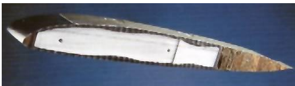
Разрез лопасти винта, заполненной Rohacell®
