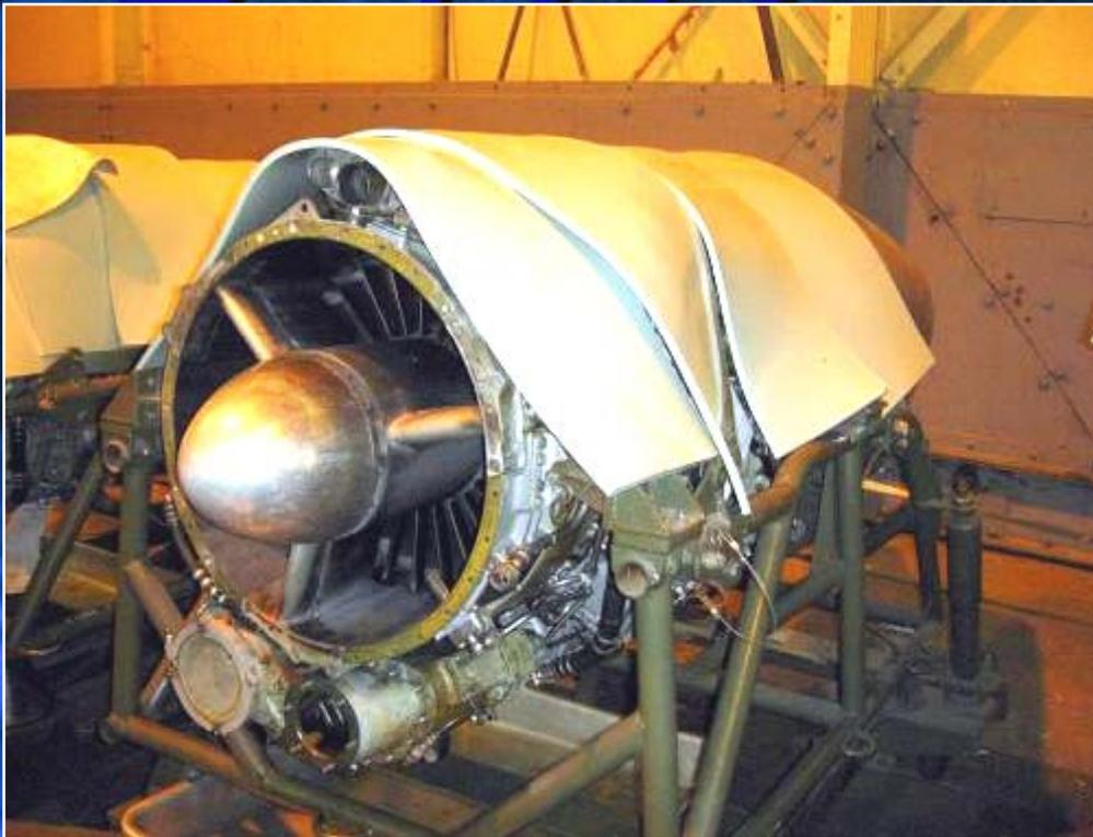
Применение полиуретана *Radishield* для временной защиты от радиации от сплавов тория на складах хранения авиационных двигателей **Rolls Royce Viper Jet**.
